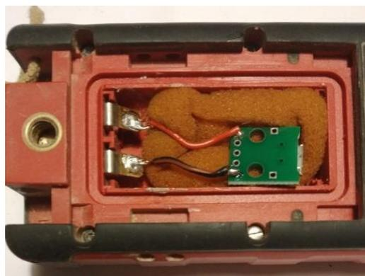
*Плата USB зафиксирована двумя каплями клея (Фото G. Sergol) или припаяна через провода. Уплотнение препятствует свободному перемещению платы USB.*
